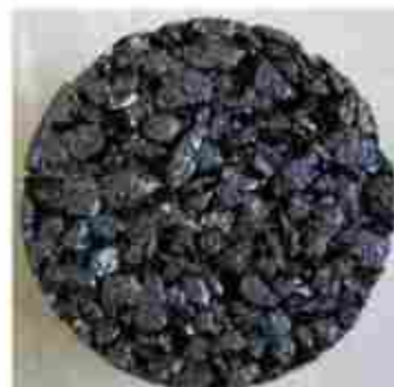
図2 健全な状態の排水性舗装試験体
