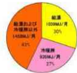
図1 計測対象住宅における全2次エネルギー消費量に対する用途別の2次エネルギー消費量の割合
